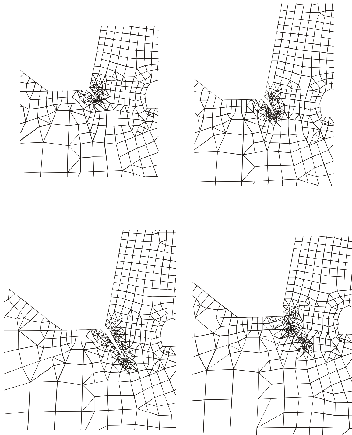
Bild 5: Verschiebungszustände während des Risswachstums
